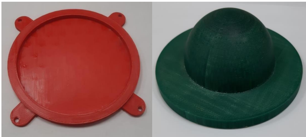
Рис. 7. Внешний вид посадочного места и подшипника для аэродинамического подвеса
